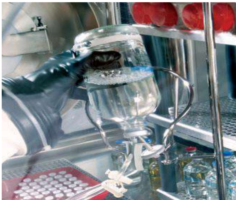
Figura 5: La barra soporte para las muestras es desmontable y puede sostener viales o bolsas de plástico desde 100 ml a 1,5 l. Fotografía Cortesía de MerckMillipore
