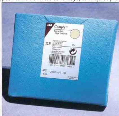
Figura 2: Ensayo o test Bowie Dick.
