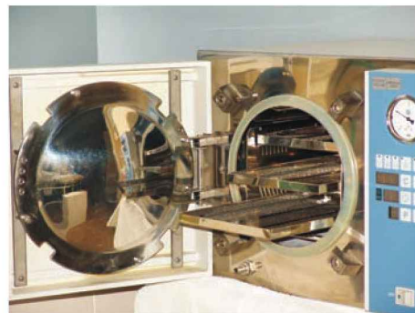
Figuras 12.13 y 12.14. Autoclave
