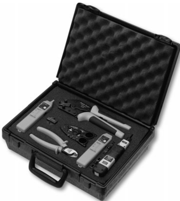
Figura 10. Algunas herramientas básicas para el administrador de redes en una empresa: pinza para armar cables, medidores de fibra óptica, alicate, etc.
