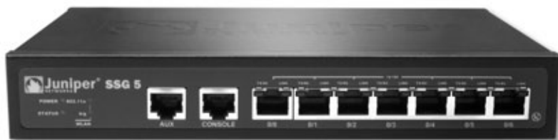
Figura 6. Los firewalls se colocan en el extremo de la red de cara a Internet. Actúan como puerta de entrada a nuestra empresa.
