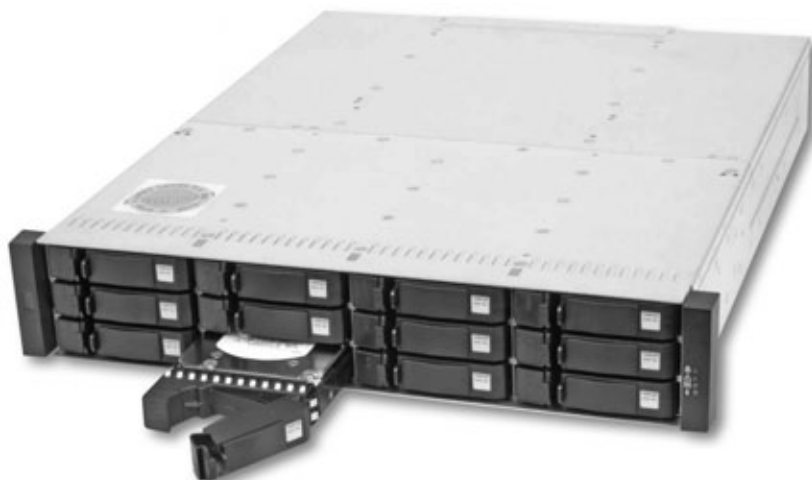
Figura 14. Hay varias empresas que se dedican a fabricar unidades de storage. Ésta tiene capacidad para 15 unidades de disco, pero esto puede variar.
