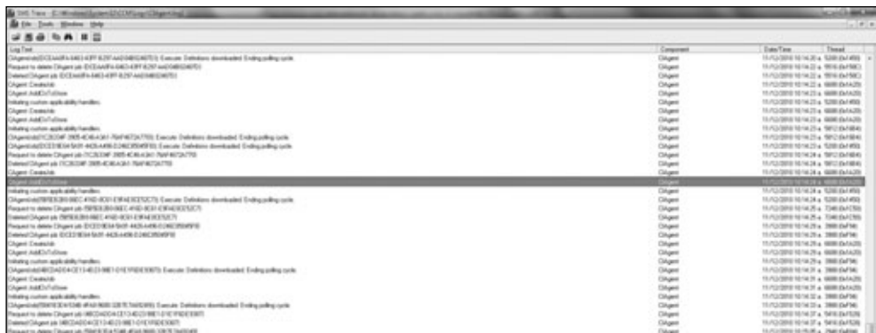
Figura 4. Podemos observar la herramienta SMS Trace analizando uno de los logs de un cliente SCCM.
