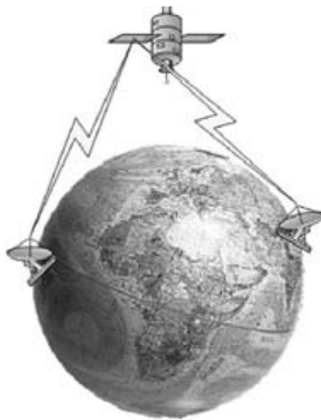
FIGURA 10.10 El satélite como reflector de señales.
