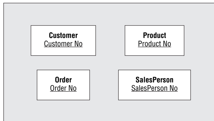
FIGURA 12.5 Tipos de entidad para el formulario de pe- dido de cliente
