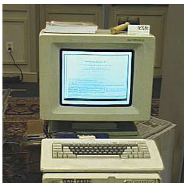
Ilustración 16 - Una máquina Symbolics 3640 Lisp: una de las primeras plataformas para sistemas expertos (Umbricht & Friend, 2010).
