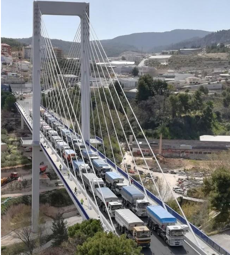
Figura 8.5. Ejemplo de prueba de carga en un puente
