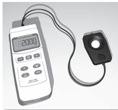
Figura 7.19 Luxómetro PCE-174 con sensor de luz y logger de datos.
