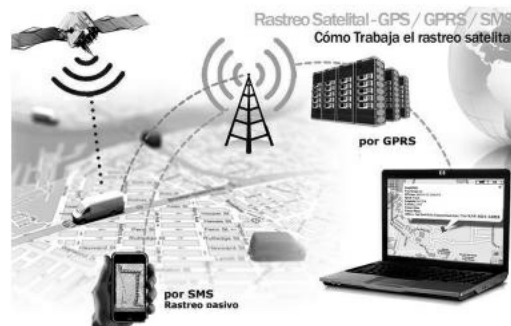
Grafica 104. Esquema operacional del GPS.
