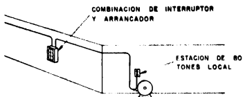
ARRANCADOR REMOTO Y LOCAL DE UN MOTOR
